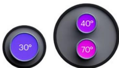
Figur 3. Principiell rörkonfiguration i ett 3-rörssystem.
