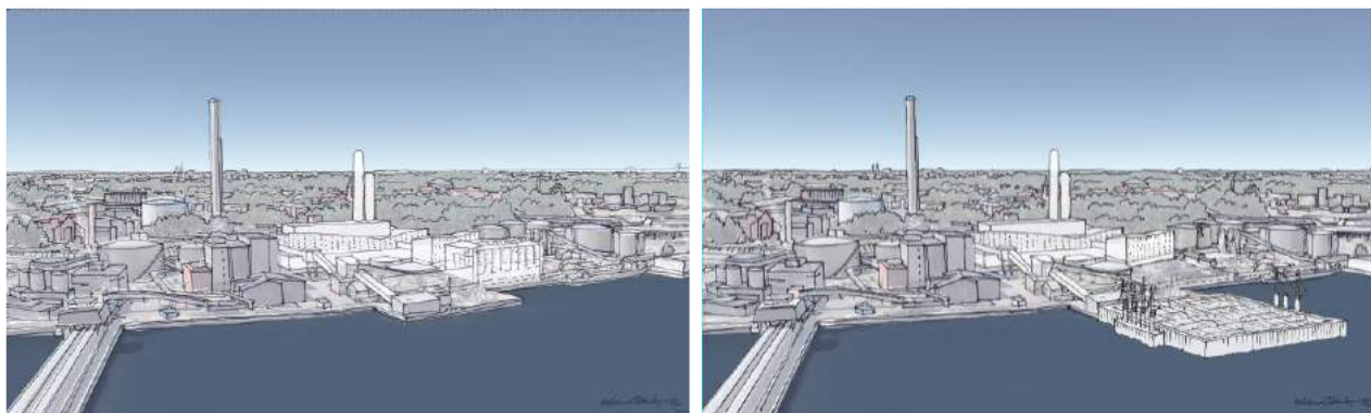
Figur 2 - Illustration med tänkbar placering och utformning av den planerade bio-CCS anläggningen. Olika utformningar och placeringar av mellanlagret på land (till vänster) och i vatten (till höger) studeras. Observera att placeringen och utformningen av anläggningen inte är bestämd då projektering fortfarande pågår för att optimera anläggningen. Urban Design, 2022.
