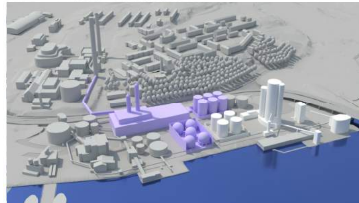
Scenario 5: Infångning, förvätskning och lagring av koldioxid
