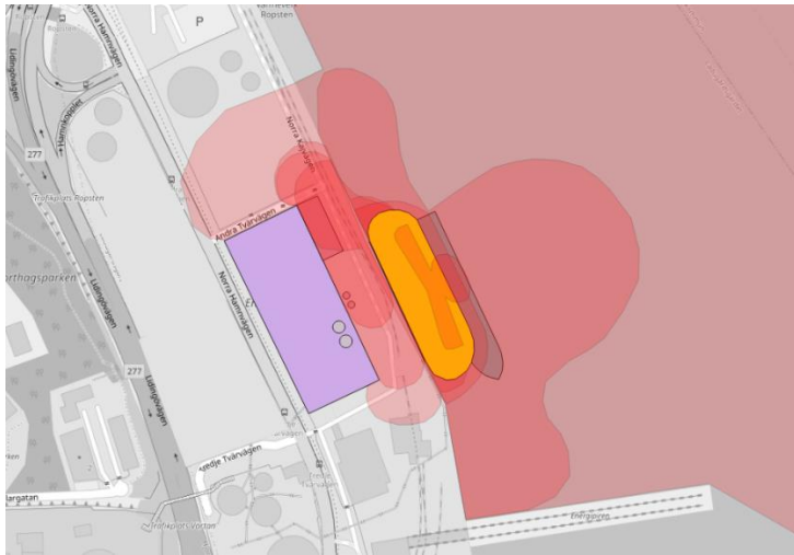
Figur 39. Risk ID 5. Kontinuerligt läckage från 10 mm hål i mellanlagringstank. Konsekvensområdets utbredning modellerat i ALOHA Modelling ID A2. 29 meter cirkulärt från resp. mellanlagringstank, med begränsning av skärmvägg mot övriga kajområdet. Antal påverkade människor uppskattas till 2 personer (inom egna verksamheten) inom detta område vid en typisk lastningsoperation.
