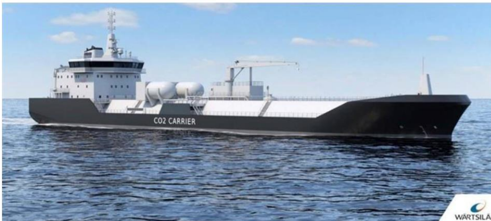
Figur 44. Exempel på design av fartyg för transport av flytande koldioxid (Wärtsilä)
