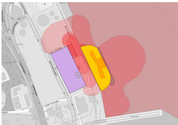
Figur 40. Risk ID 6. Läckage i rördragning mellanlager (läckagestorlek 10% av rördiameter). Konsekvensområdets utbredning modellerat i ALOHA Modelling ID A4. 47 meter cirkulärt från resp. mellanlagringstank, med begränsning av skärmvägg mot övriga kajområdet. Antal påverkade människor uppskattas till 2 personer (inom egna verksamheten) vid en typisk lastningsoperation.
