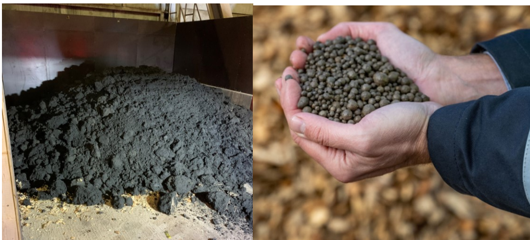
Figur 32. Rötat slam (tv) förbränns och flygaskan granuleras (granuler th) med ambitionen att kunna tillföra näringsämnen till skogen.
