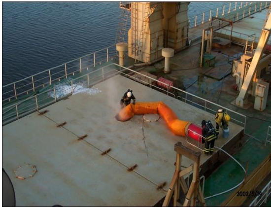
Bild 1 Påföring av skum till lastutrymmet. ©Martin Uulas
