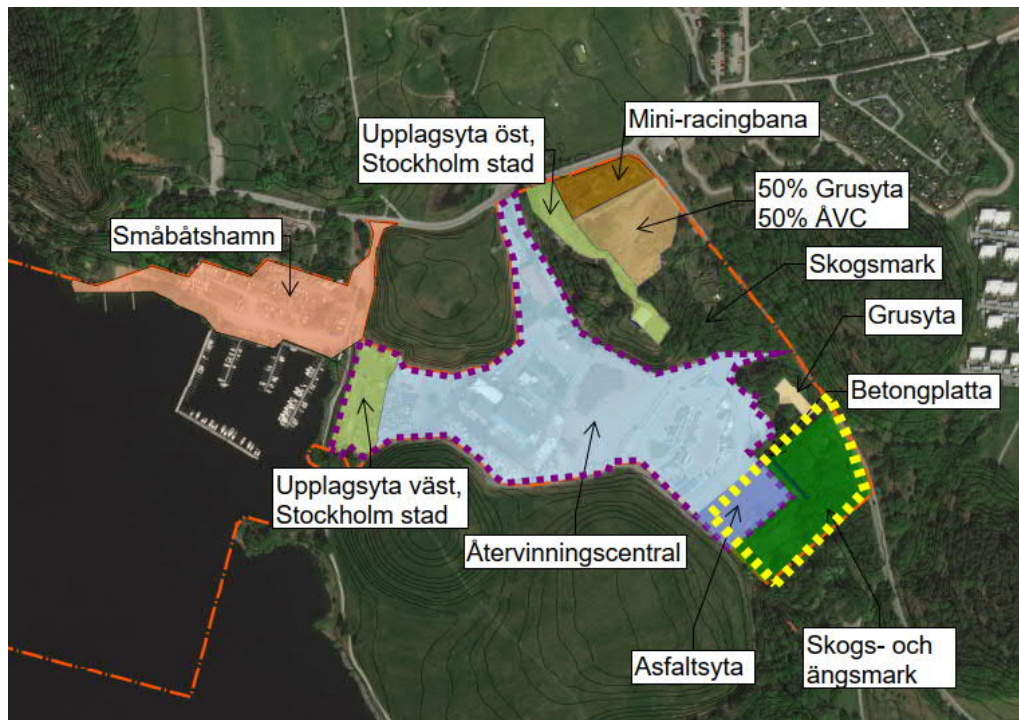
Figur 8. Markanvändning för befintligt scenario inom utredningsområdet. Lila streckad linje markerar det område som avvattnas via två oljeavskiljare. Provtagning av SVOA sker på vattnet efter de två oljeavskiljarna. Området markerat med gul streckad linje utgörs av den framtida ÅVC:n och ingår inte i denna tillståndsansökan.
