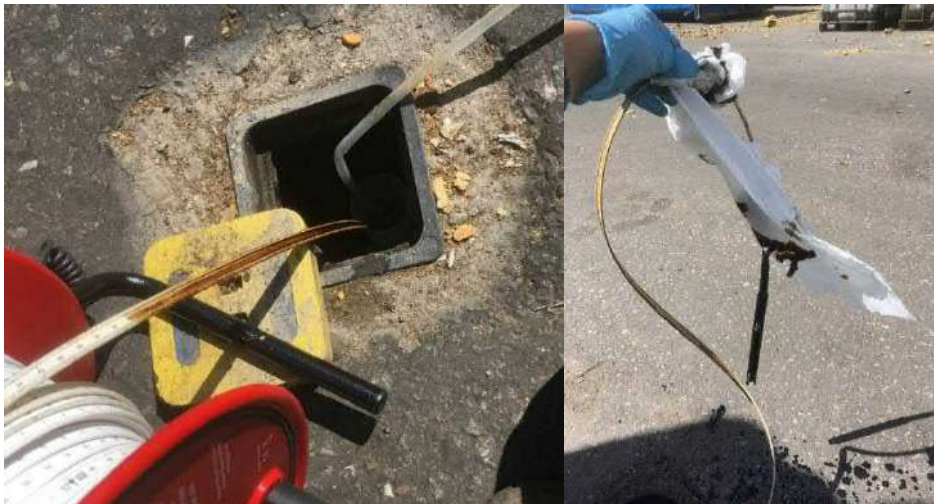
Figur 5-38: Foto från tvåfaslodning där förekomst av olja tydligt observerades på måttbandet
