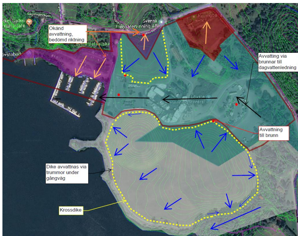
Figur 9-2. Befintligt område och översiktliga avvattningsvägar. Blå pilar avser avrinningsriktningar från mark och svarta pilar ledningsbunden avrinning. Orangea pilar markerar bedömd avrinningsriktning från områden med okända dagvattenanläggningar.
