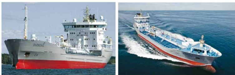
Figur 18. Ternhus, Längd 115 meter, bredd 18 meter. Last: 5 800 ton bensin och diesel fördelat i 2 x 5 tankar, som vardera symmetri mellan 1165 och 2 289 kubikmeter. Dubbelbalkar > 1,5 meter. Bunkar: IFO/MGO 100 ton, diesel 30 ton. (Foto: Kärntank) Figur 19. Ternhus Längd 141 meter, bredd 21 meter. Last: 9 800 ton bensin och diesel fördelat i 2 x 7 tankar, som vardera symmetri mellan 1 217 och 2 283 kubikmeter. Dubbelbalkar > 1,5 meter. Bunkar: IFO/MGO 100 ton, diesel 30 ton.
