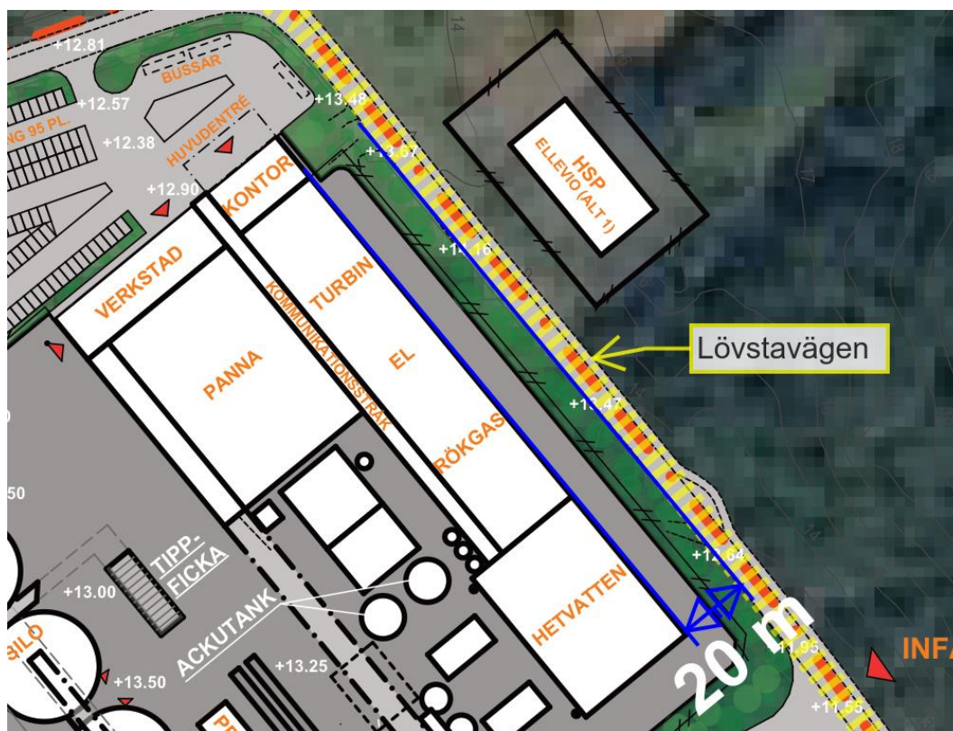
Figur 5. Illustrerar den rekommenderade sekundära transportleden för farligt gods (streckad gul) samt avståndet, drygt 20 m till byggnaderna på anläggningen enligt planförslag.
