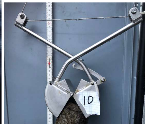
Figur 16: Yoldias sedimentprovtagare/rörprovtagare 15 kg med innerdiameter 64 mm. Van Veen provtagare.
