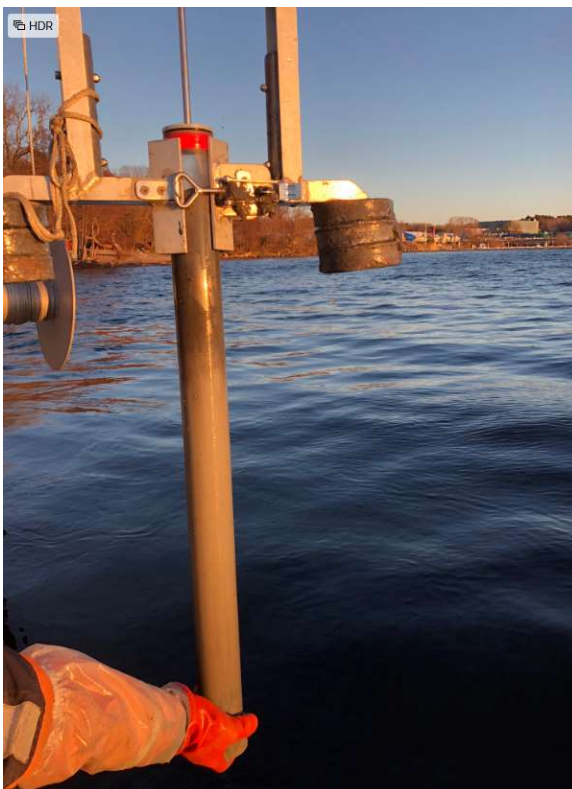
Figur 16: Yoldias sedimentprovtagare/rörprovtagare 15 kg med innerdiameter 64 mm. Van Veen provtagare.
