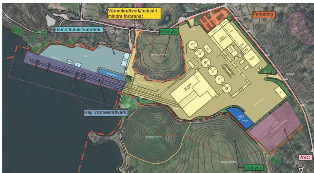
Figur 9 - Översikt över planförslaget med indelning utefter den markanvändning som används vid föreningsmodellering i StormTac. Den underliggande situationsplanen beskriver planförslaget medan de överlagrade färgfälten anger den markanvändning som antagits för föreningsberäkningar i StormTac. Röd heldragen linje visar utredningsområdet.
