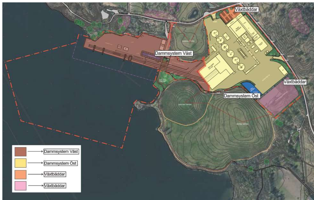
Figur 10 - Avrinningsområden till respektive föreslagna reningsanläggningar markeras med olika färger. Rött område avleds till dammsystem väst, gult område avleds till dammsystem öst och orangefärgat och rosa område avleds till växtbäddar. Röd streckad linje markerar vattendelare.
