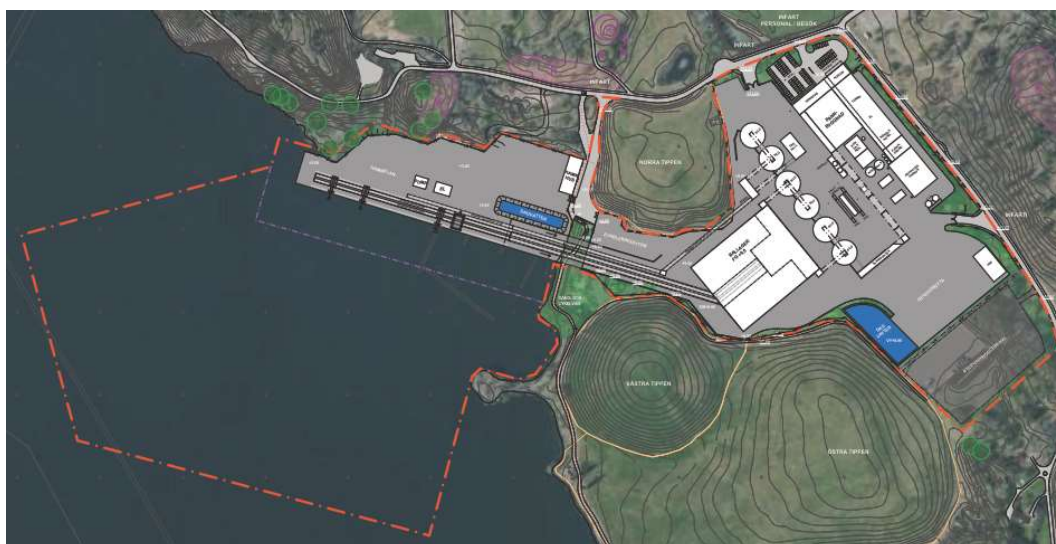
Figur 7 – Planerad anläggning i översikt. Planområdet är markerat med orange prickstreckad linje. De två dammsystemen (väst och öst) som föreslås som främsta dagvattenhanteringsåtgärd kan ses i planen (blåa ytor).
