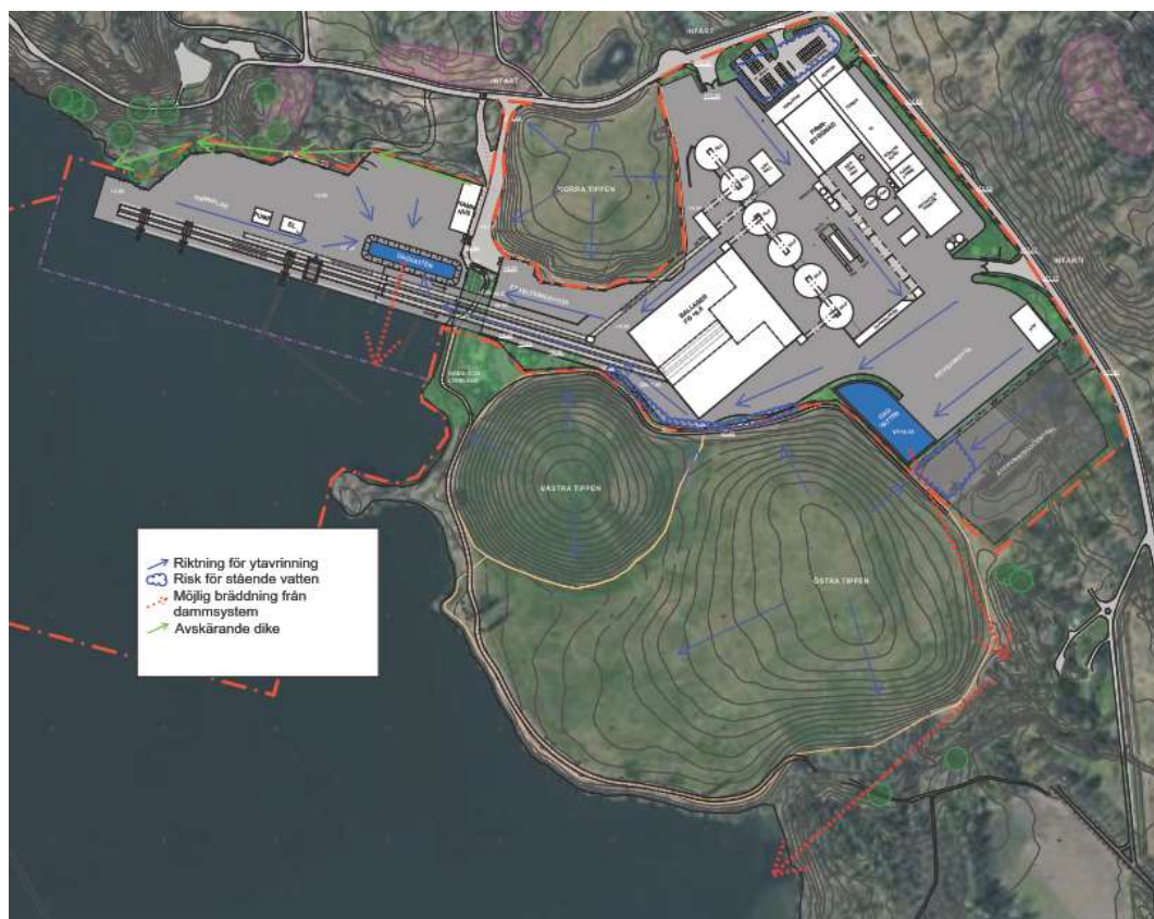
Figur 21 – Skyfallsscenario. Ytvavrinning, möjlig bräddning och risk för stående vatten är utmärkt i figuren.
