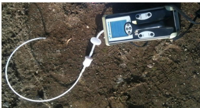
Figur 5. Multigasmätare (av typ Ecoprobe 5 från RS Dynamics)
