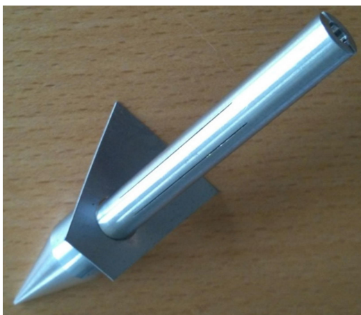
Figur 4. Porgasspets av aluminium (diameter 16 mm, s.k. KVA shield point) utrustad med ett antal 0,2 mm slitsar.
