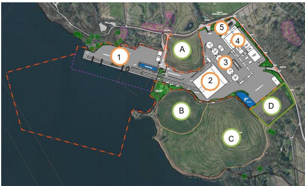
Figur 4-1. Planerad översiktlig utformning av den nya energianläggningen i Lövsta. Siffrorna anger plats för anläggningens (1) hamnområde, (2) ballager, (3) bränslelager (4) huvudbyggnad och (5) personalbyggnad och parkering. Utanför verksamhetsområdet finns de sluttäckta deponikullarna: (A) Norra deponin, (B) Västra deponin och (C) Östra deponin samt (D) plats för återvinningscentral.
