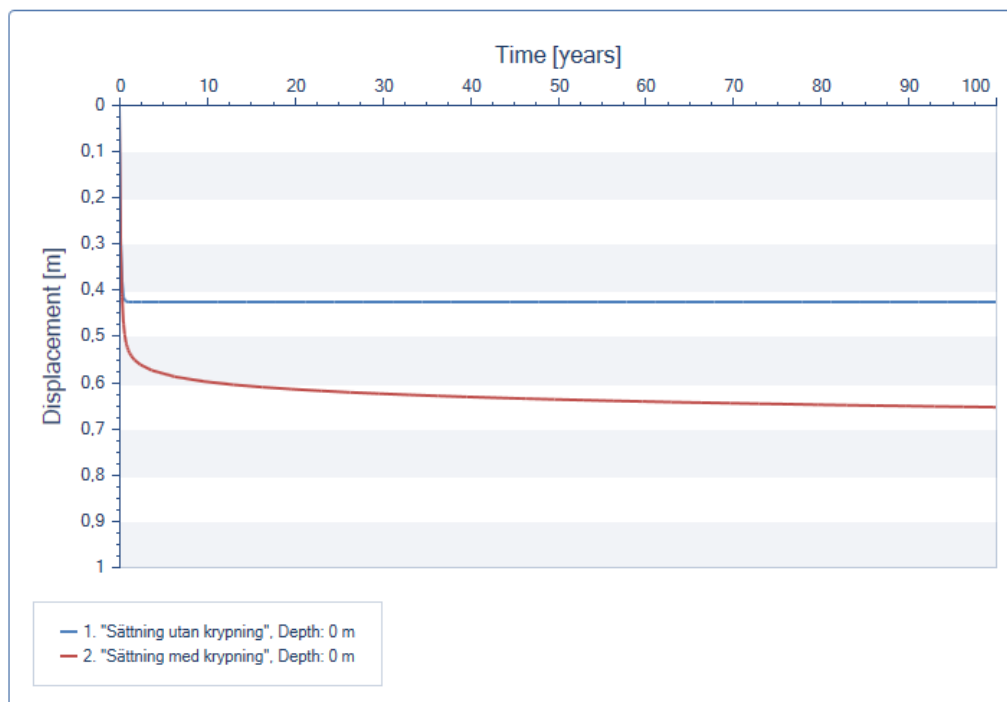
Figur 11.2. Sättningar i kajsektion 0/200.
